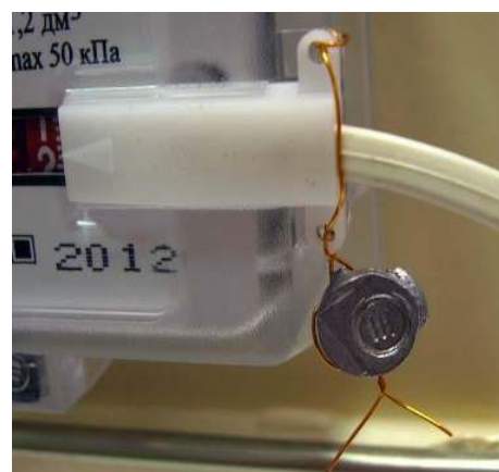
Рисунок 4 Схема пломбировки датчика импульсов
